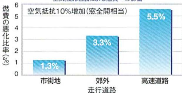
・2,000ccの乗用車を使用して実験室で計測
